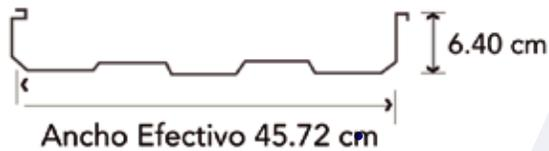
**CONSTRUSTANDING SEAM**, es un sistema innovador para la fabricación en sitio de cubiertas y fachadas sin traslapes, con un acabado homogéneo que caracteriza construcciones industriales para obras que requieren pendientes mínimas de un 5%, sellado herméticamente al utilizar anclajes ocultos.
